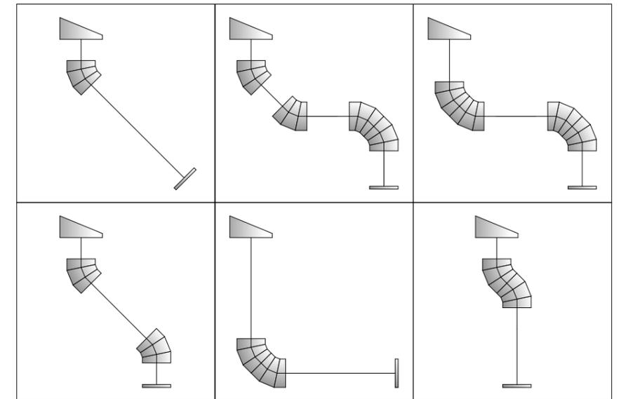
При отсутствии возможности установки световой трубы по прямой линии (перпендикулярно относительно плоскостей корпуса и рассеивателя) используются зеркальные угловые отводы.
