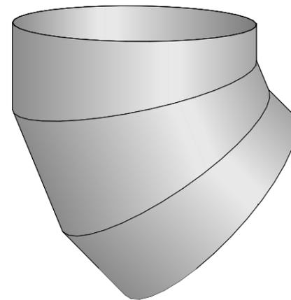
Схема устройства световода с угловыми отводами
